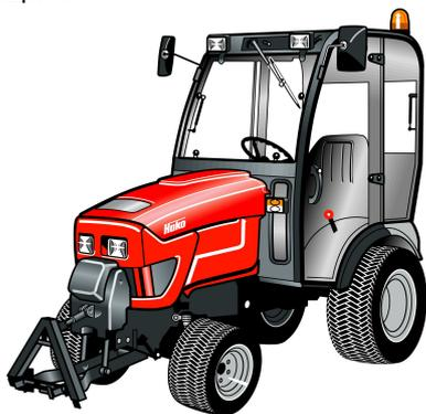
**Двигатель:** 3 цилиндровый дизельный двигатель Yanmar 1.331 см<sup>3</sup> с водяным охлаждением; 21,9 кВт (29,8 л.с.), при 3000 1/мин.-1 (согласно стандарту SAE - Общества автомобильных инженеров), 19,8 кВт (26,9 л.с.) при 2600 1/мин.-1 (ECE R24 - Европейская экономическая комиссия ООН). Объем топливного бака: 26 л. Двигатель не превосходит предельные величины в соответствии с европейской директивой 97/68 ЕС ступень IIIA.
