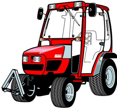
**Двигатель:** 3 цилиндровый дизельный двигатель Yanmar 1.006 см<sup>3</sup> с водяным охлаждением; 16,6 кВт (22,6 л.с.), при 3000 1/мин.-1 (согласно стандарту SAE - Общества автомобильных инженеров), 14,2 кВт (19,3 л.с.) при 2650 1/мин.-1 (ECE R24 - Европейская экономическая комиссия ООН). Объем топливного бака: 22л. Двигатель не превосходит предельные величины в соответствии с европейской директивой 97/68 ЕС ступень II.
