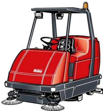
Электронасос для дозированной подачи рабочего раствора на щётки. Мощные трёхступенчатые турбины и влагосборный скребок параболической формы с плавающей подвеской обеспечивают высокий уровень сбора влаги.
