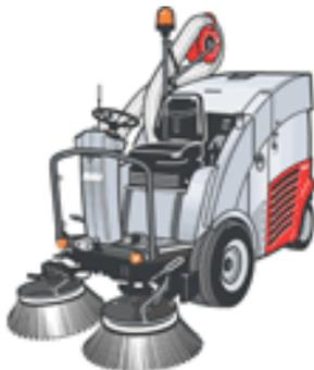
**Двигатель:** 2-х цилиндровый дизельный двигатель Lombardini LDW 702 B4, с жидкостным охлаждением, с закрытой системой охлаждения. Рабочий объем 686 куб. см., с регулируемым числом оборотов 9,7 кВт (13,2 л.с.) при 2500 об/мин. Макс. крутящий момент: 40 Nm при 2200 об/мин. Воздушный фильтр с большим рабочим объемом. Топливный бак: 20 литров
