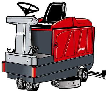
**Привод движения:** бесступенчатая регулировка скорости движения и уборки посредством электронного управления (импульсное управление) 0-6 км/ч. Энергия торможения используется для подзарядки АКБ. Высокомощный двигатель с резервом мощности для преодоления подъёмов до 10% в рабочем режиме.
