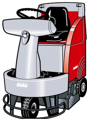
**Привод движения:** бесступенчатая регулировка скорости движения и уборки - электронное управление (импульсное управление), 0-6,5 км/ч. Энергия торможения используется для подзарядки АКБ. Высокомощный двигатель с резервом мощности для преодоления подъёмов до 10% в рабочем режиме.
