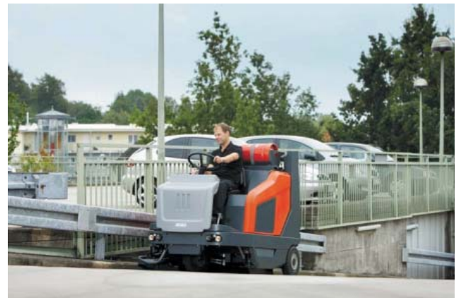
Nako-Jonas 1500 с газотопливной установкой
