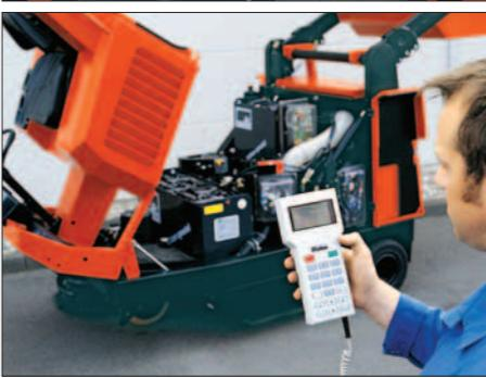
следить всю историю сервисного обслуживания машины. Конструкция Hakomatic B1100 обеспечивает прямой и простой доступ ко всем рабочим узлам машины для проведения необходимого сервисного обслуживания.
