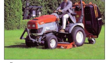
ней части трактора, а между осями, что делает машину более маневренной и облегчает работу на пространствах со сложной геометрией (например, при окапывании клумб).
