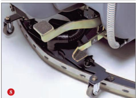
блоке, хочется упомянуть еще одно такое комплексное решение — конструкцию фартука и его крепление. Крепление — металлическая лента-хомут, пущенная, как и фартук, по периметру щеточного блока, защищает фартук от повреждений, а утолщения фартука «прикрывают» крепление снизу и сверху (одновременно являясь демпферами щеточного узла), не давая возможности какому бы то ни было препятствию «подцепить» и сорвать крепление.
