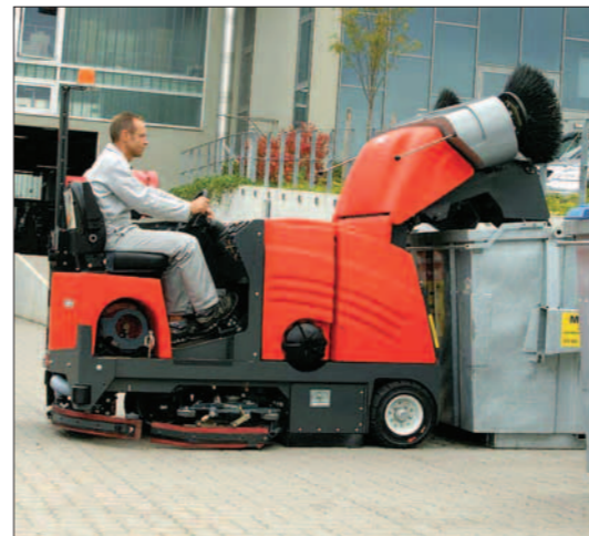
Гидравлическая система разгрузки мусоросборника с подъемом до высоты 1520 мм. Объем мусоросборного бака — 240 литров.
