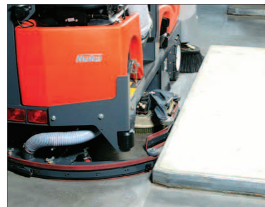
Оптимальная работа около стен и бордюров: элементы систем предварительного подметания и влажной очистки вынесены в сторону за габариты машины, но при соприкосновении с препятствием свободно уходят «под» нее.
