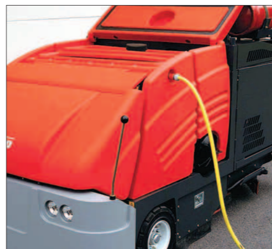
Свободный доступ к бакам и легкое их опорожнение вместе с системой автоматического отключения подачи воды при заполнении бака сокращает время на перезаправку машины.
