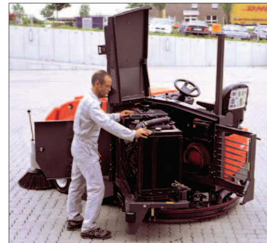
Чрезвычайно удобное обслуживание силовой установки, приводных и внутренних систем за счет «открывающегося» подрамника двигателя.
