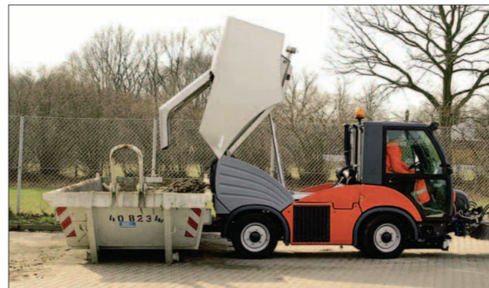
Разгрузка мусоросборного бака осуществляется с помощью гидравлики и занимает очень мало времени
