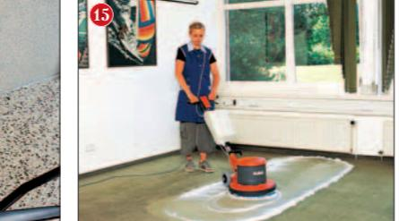
не при скорости вращения 1100 оборотов в минуту. Машина предназначена для полировки, очистки и нанесения моющих средств при работе со всеми типами твердых напольных покрытий. Так же, как и на двух предыдущих моделях, здесь предусмотрена установка вакуумного агрегата.
