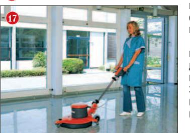
ра при скорости вращения 1100 оборотов в минуту. Машина предназначена для полировки, очистки и нанесения моющих средств при работе со всеми типами твердых напольных покрытий. Так же, как и на двух предыдущих моделях, здесь предусмотрена установка вакуумного агрегата.
