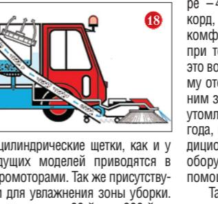
Боковые цилиндрические щетки, как и у двух предыдущих моделей, приводятся в действие гидромоторами. Так же присутствуют форсунки для увлажнения зоны уборки. Но в отличие от машин «90-й» и «300-й» у **Hako-Citymaster 1800** регулировка щеток по ширине, скорости вращения и прижиму осуществляется из кабины, причем, на ходу. Эти настройки для левой и правой щеток можно осуществлять независимо (16).
