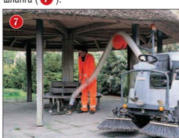
**Hako-Citymaster 90** имеет высокую маневренность за счет того, что заднее управляемое колесо может поворачиваться на 60°. Во время уборки аппарат может преодолевать препятствия высотой до 13 см (высота бордюрного камня в Европе) (8). Привод на передние колеса обеспечивает дизельный
