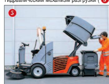
Очищенный картриджным фильтром воздух выбрасывается из машины наружу. Для того чтобы переместить мусор в зону всасывания, **Hako-Citymaster 90** имеет две дисковые щетки, слева и справа (6).
