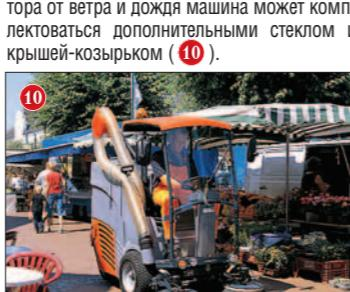
Рабочая ширина зависит от расстояния между щетками. Эта настройка производится снаружи до начала работы. Также регулируется и прижим щеток — заранее и для обеих щеток сразу.
