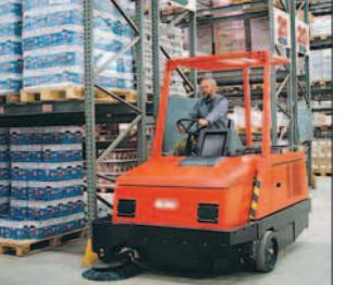
**Hako-Jonas 1700.** Высокоэффективная подметальная машина для уборки больших площадей. Приспособлена для уборки сильно загрязненных участков. Гидравлическая система опорожнения мусоросборника. Оснащается либо ДВС (бензиновый, дизельный или газовый), либо электродвигателем с питанием от аккумулятора. Производительность до 18400 м<sup>2</sup>/ч.
