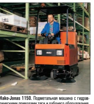
**Hako-Jonas 1150.** Подметальная машина с гидравлическими приводами тяги и рабочего оборудования. Оснащена автоматической системой опорожнения контейнеров. Оснащается либо ДВС (бензиновый, дизельный или газовый), либо электродвигателем с питанием от аккумулятора. Производительность до 12150 м<sup>2</sup>/ч.
