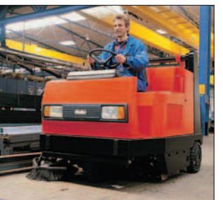
**Hako-Jonas 1450.** Подметальная машина с гидравлическими приводами тяги и рабочего оборудования. Возможность включения запрограммированных функций уборки одной кнопкой. Гидравлическая система опорожнения мусоросборника. Оснащается либо ДВС (бензиновый, дизельный или газовый), либо электродвигателем с питанием от аккумулятора. Производительность до 16200 м<sup>2</sup>/ч.
