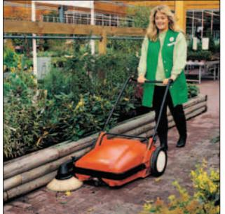
**Hako-Profi-Flipper.** Ручной подметальный механический аппарат для маленьких площадей. Мусоросборный контейнер выполнен из ударопрочного пластика. Для удобства работы скоба-штанга может быть закреплена в одном из двух возможных положений. Небольшой вес (24 кг) позволяет легко транспортировать аппарат даже по лестничным пролетам. Производительность до 2300 м<sup>2</sup>/ч.
